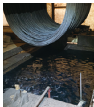
酸洗ライン硫酸槽と今回導入したブローア
