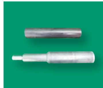
動力伝導シャフト(上:材料、下:製品)
